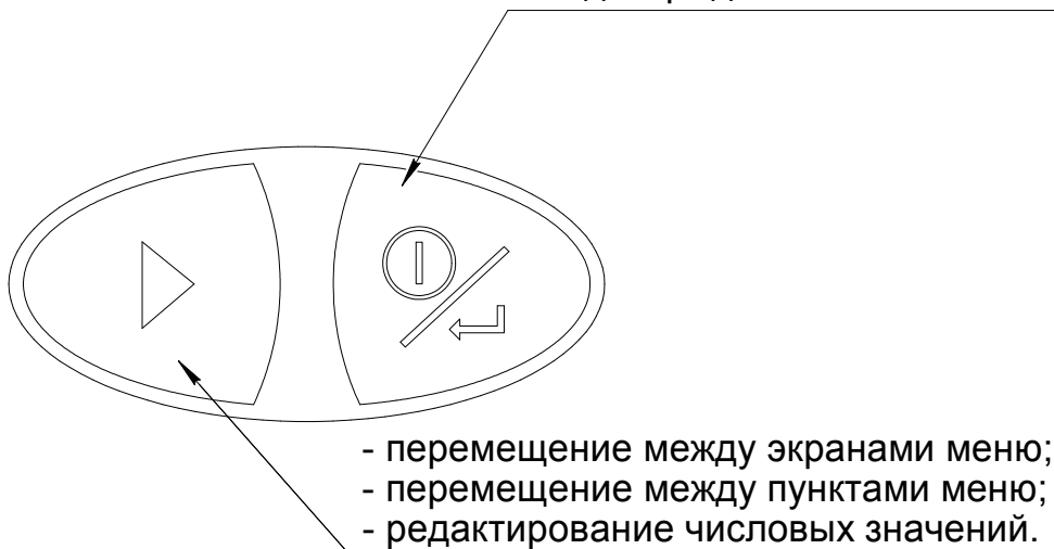
Рисунок 1.4 – Внешний вид и назначение кнопок клавиатуры
