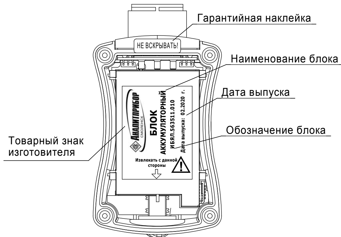
Рисунок 1.6 – Маркировка аккумуляторного блока и расположение гарантийной (пломбировочной) наклейки
