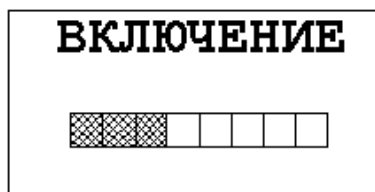
Рисунок 2.1 – Вид табло при включении газоанализатора
