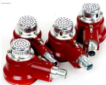
Термохимический датчик во взрывозащищённом корпусе АПИ5.132.039 (низкотемпературное исполнение) предназначен для преобразования величин до взрывоопасных концентраций горючего газа, паров и их смесей в величину постоянного напряжения, пропорциональную тепловому эффекту, создаваемому при окислении измеряемого газа.
