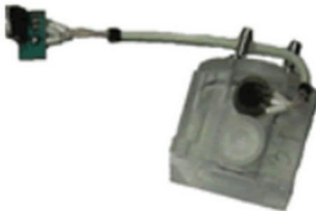
**Двухэлектродная электрохимическая ячейка ИБЯЛ.305649.036** предназначена для преобразования величины концентрации кислорода ( $O_2$ ) в величину электрического сигнала, пропорциональную объёмной доле измеряемого компонента в детектируемой газовой смеси.
