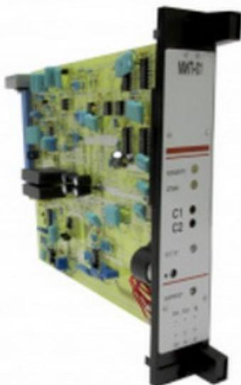
МПОП-10 ИБЯЛ.418112.034 и МПОП-25 ИБЯЛ.418112.034-01 модули преобразователя основного питания предназначены для работы в составе газоанализаторов СТМ-10.
