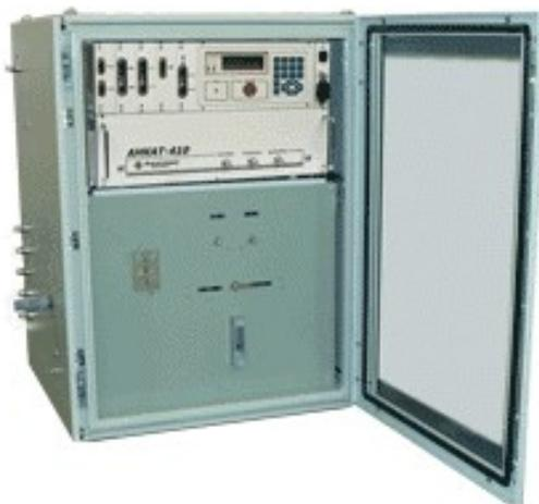
Шкаф предназначен для защиты газоанализаторов от климатических факторов внешней среды, доставки, осушения, очистки и сброса анализируемой газовой смеси, обеспечение продувки датчиков атмосферным воздухом, удаления конденсата.
