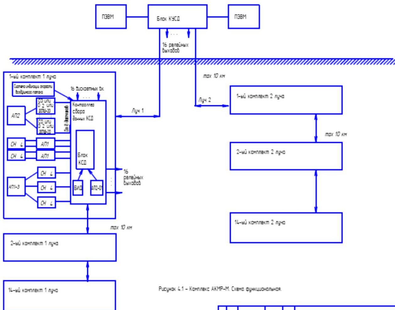
Рисунок 4.1 – Комплекс АКМР-М. Схема функциональная.
