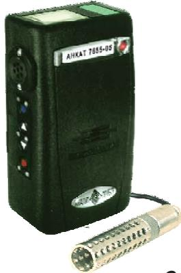
**Предназначены** для автоматического непрерывного измерения концентрации растворенного кислорода и температуры (только АНКAT7655-05).
