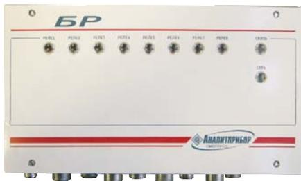
**Предназначен** для коммутации внешних исполнительных устройств по командам, поступающим от ведущего устройства сети по интерфейсу MODBUS RTU и устанавливается во вне взрывоопасных зон помещений и наружных установок.
