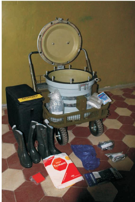
Изделие предназначено для локализации, безопасной эвакуации и хранения до девяноста суток объектов, содержащих особо опасные химические вещества и представляющих потенциальную химическую или биологическую опасность.
