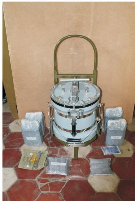
Изделие предназначено для локализации, безопасной эвакуации и хранения сроком до девяноста суток объектов, содержащих особо опасные химические вещества и представляющих потенциальную химическую или биологическую опасность.
