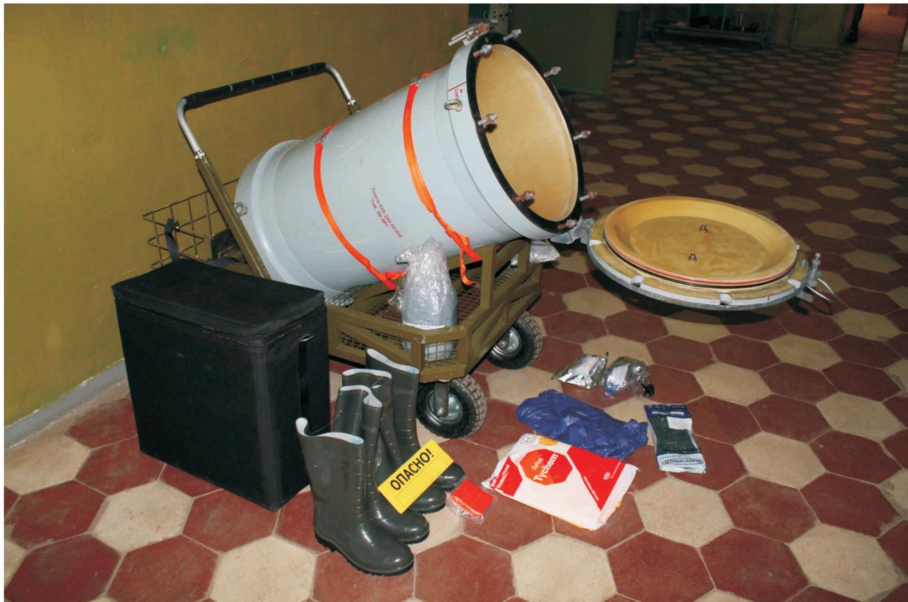
Изделие предназначено для локализации, безопасной эвакуации и хранения до девяноста суток объектов, содержащих особо опасные химические вещества и представляющих потенциальную химическую или биологическую опасность.
